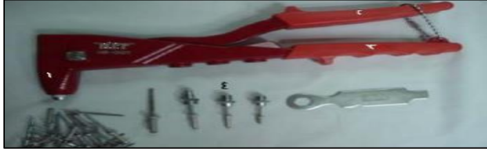
شكل رقم (١٧) ماكينة البرشام اليدوية وأجزاء مسامير البرشام المصدر: أحمد أسامة سمعني، أساسيات تشغيل المعادن وزارة الصناعة والتجارة الخارجية، ص ٢٥.
