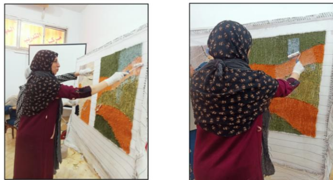
شكل (8) أحد المتدربات أثناء دهان المادة اللاصقة على ظهر السجادة
