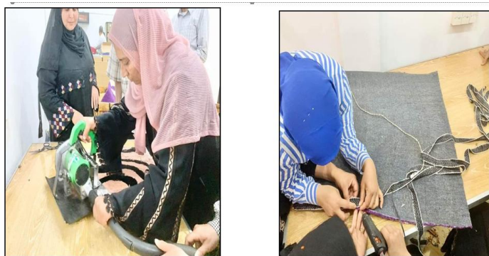
شكل (11) المتدربات أثناء إستخدام ماكينة تسوية الوبره وتثبيت الشريط النهائى على أطراف السجادة من الخلف
