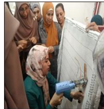
شكل (4) يوضح الباحثة أثناء تدريب السيدات على كيفية تشغيل المسدس وغرز الوبرة على القماش
