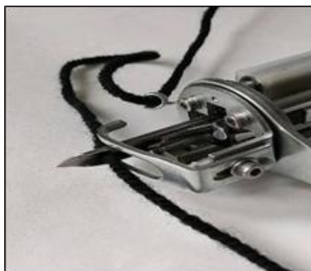
شكل (1) يوضح دخول خيوط الوبرة بإبرة مسدس التافت
