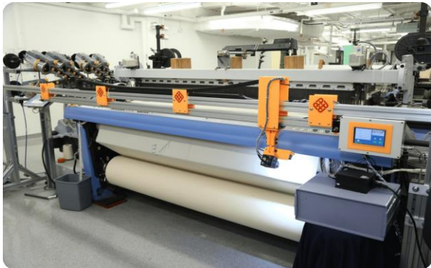
شكل (١): ماكينة النسيج وتحديد العطلات بالماكنة
