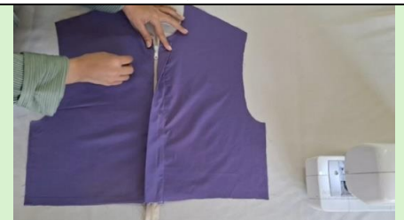
٣٠- الشكل النهائي لسوستة الأمام المخفية بعد تركيبها.
