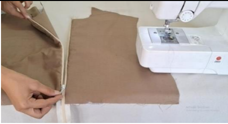
٢٠- الشكل النهائي بعد تجميع السوستة والبطانة مع صدر الأمام.
