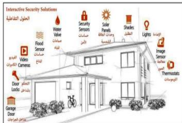
شكل (٢) يوضح الحلول التفاعلية للمسكن الذكي (حساسات المناخ- الكاميرات- أجهزة الانذارات- التحكم في فتح وغلق عناصر من المسكن... الخ) بما يحقق الكفاءة والاستدامة في استخدام الطاقة والحفاظ على البيئة.
