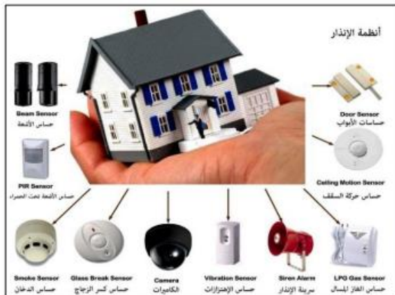
شكل (٣) يوضح أنظمة الانذارات المتنوعة والحساسات المستخدمة في المسكن الذكي والتي تحقق الامن والسلامة والحفاظ على البيئة داخل المسكن محققاً احتياجات المستخدم بشكل أكثر كفاءة.
