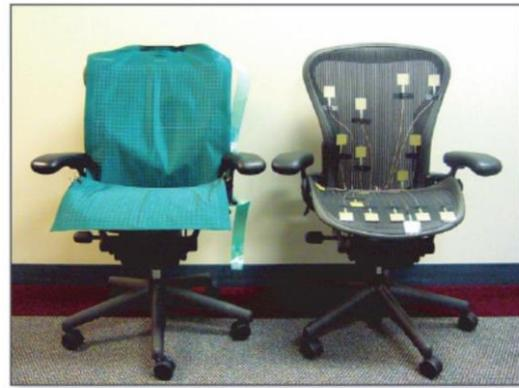
الصورة (١) توضح شكل الكرسي الحساس مع شكل خرائط الضغط عند الجلوس (١٤)
