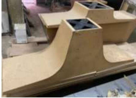
شكل (25) القاعدة المنحنية من ألواح الأبلاكاج الطبقات 12 mm PlyWood تم كسوتها بخامة الجلد الطبيعى و ذلك لحجب المسامير الخاصة بالتجميع ، و إضافة مظهراً يتسم بالأناقة و الحداثة.
