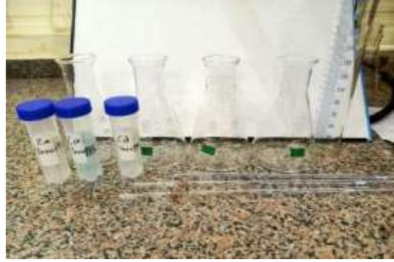
شكل (4): أدوات التجربة (أنابيب فالكون، ماصات، 4 دورق مخروطي)
