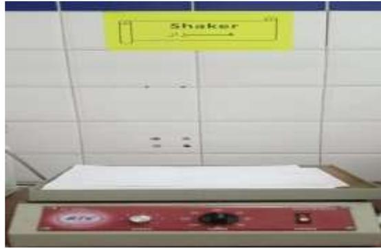
شكل (5): جهاز الرج Shaker المستخدم لمزج العينات في الدوارق بشكل دائري مستمر بسرعة 400 r.p.m.
