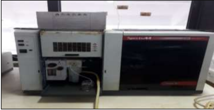
الشكل (٢): صورة تظهر جهاز امتصاص الطيف الذري نوع Varian 220
