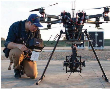
شكل رقم (19) الكاميرا العنكبوتية وجهاز التحكم عن بعد بالكاميرا والطائرة
