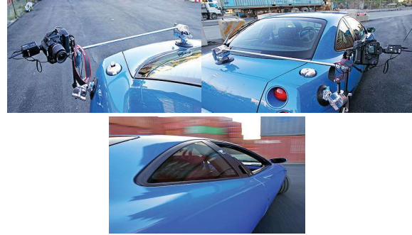
شكل رقم (13) شكل وضع الكاميرا الرقمية مثبتة بالحلقة على جسم السيارة من الخارج
