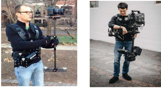
شكل رقم (14) الفرق بين ستيدى كام كبير الحجم والوزن بما هو صغير الحجم وخفيف الوزن
