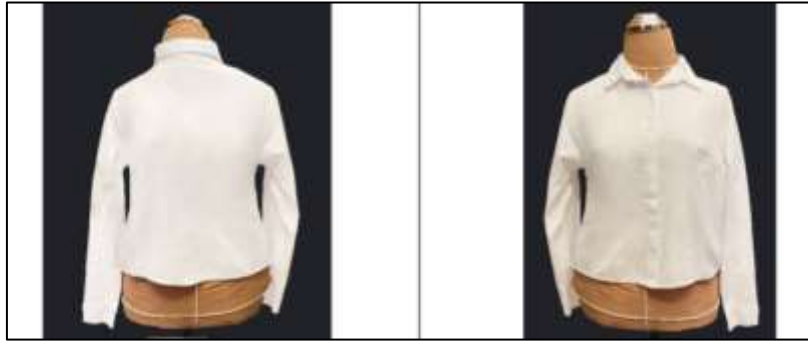
صورة (٦) العينة المنفذة (قميص) باستخدام النموذج المعدل للكورساج
