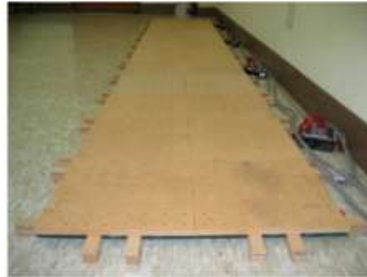
صورة رقم (٢) توضح الهيكل العام لـ UbiFloorII والذي يتكون من وحدة التحكم الدقيقة القاطع الضوئي- شبكة منطقة التحكم -حاسب مركزي- خلايا (بلاطة). (١٧: ص 2617-2618)
