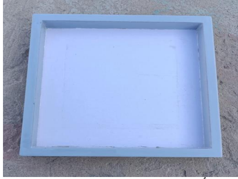
شكل (١٥) قالب خشب بأبعاد ٣٠*٣٠*٣ سم مدعم بطبقة من الإيبوكسي لتحمل درجات الحرارة العالية.
