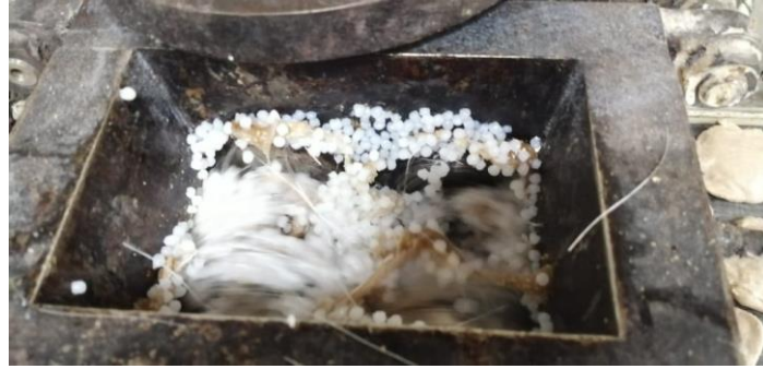
شكل (١٢) عملية خلط المواد في المكسر.
