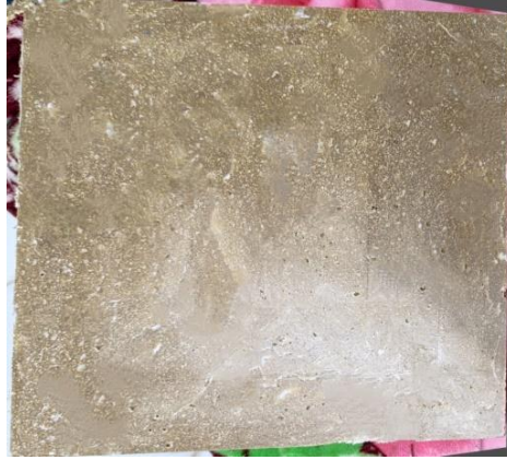
شكل (١٦) البلاطة بعد الكبس وقبل الصنفرة.
