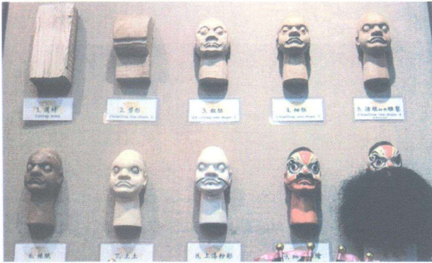
طريقة عمل رأس عرائس الخيز "الماريونيت" من الخشب
