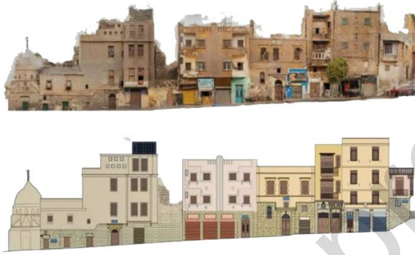
شكل رقم ٥ تأهيل منطقة درب اللبانة، ترميم للمنازل القديمة والواجهات ذات الطابع العمراني القديم
