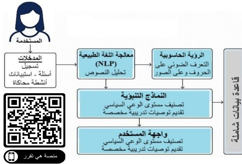
شكل (٨) المخطط المعماري التقني المقترح لمنصة "هي تقرر" ومقترح برمجي مرئي لها.
