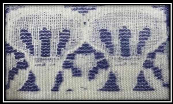
صورة (٩-ج) استخدام عازل قصاصات الورق بين الوسيط الطباعي والقماش
