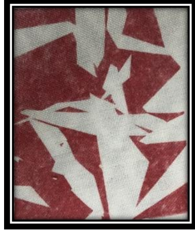
صورة (٩-ج) استخدام عازل قصاصات الورق بين الوسيط الطباعي والقماش
