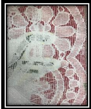
صورة (٩-ج) استخدام عازل قصاصات الورق بين الوسيط الطباعي والقماش
