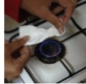
شكل (١٤): تعريض التايك للنار المباشرة
