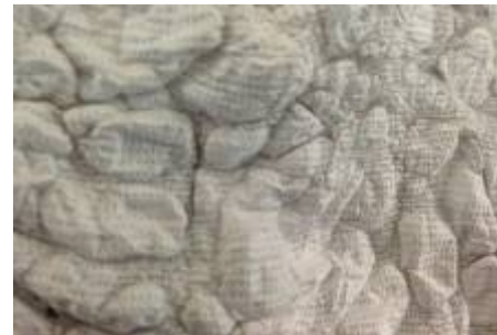
شكل (١٥): سطح التايك بعد تعريضه للنار
