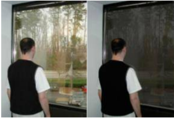
(شكل 26) النوافذ الذكية بتقنية " الجسيمات المعلقة "
