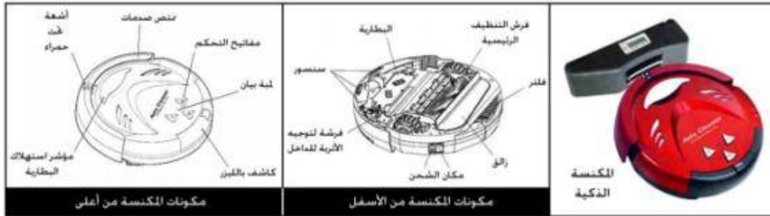
(شكل 33) المكنسة الذكية ومكوناتها من أسفل ومن أعلى
