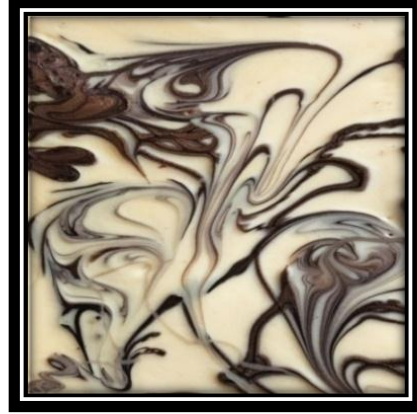
شكل (٣) تأثير زيادة المصلب ( البوليستر المعتم )
