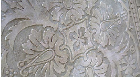
(شكل ١٥) تشكيلات نباتية مستوحاة من الزخارف الإسلامية تم تنفيذها على خشب MDF بواسطة ماكينة الروتر الرقمية.
