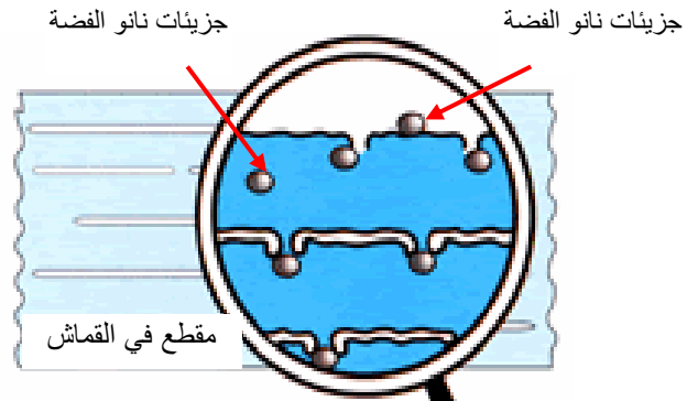
معالجة قماش تريكو الجوارب ضد البكتيريا باستخدام نانو الفضة مع استخدام الضغط المناسب
