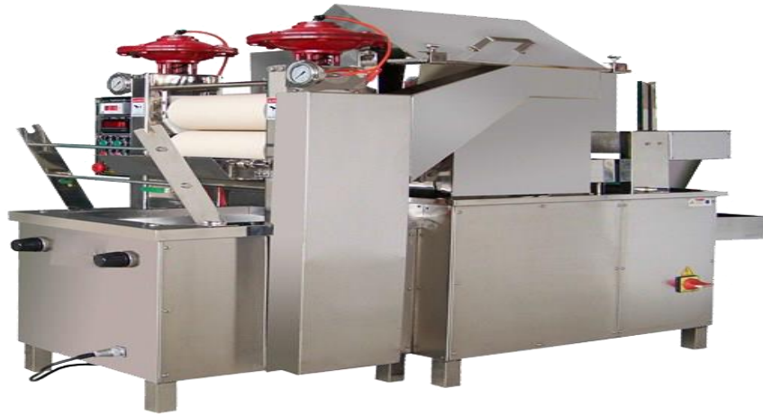
شكل (1) ماكينة معالجة القماش بنانو الفضة Laboratory Padding Machine
