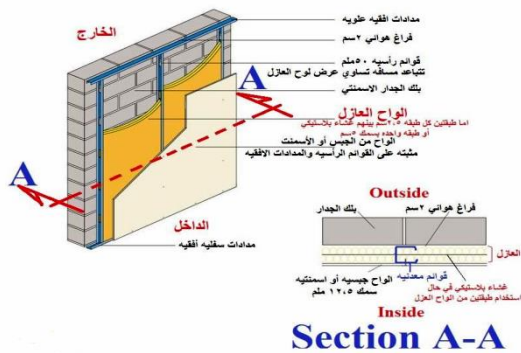
صورة (٨) توضح تركيب خامات العزل الصوتي والحراري بحائط خارجي .
