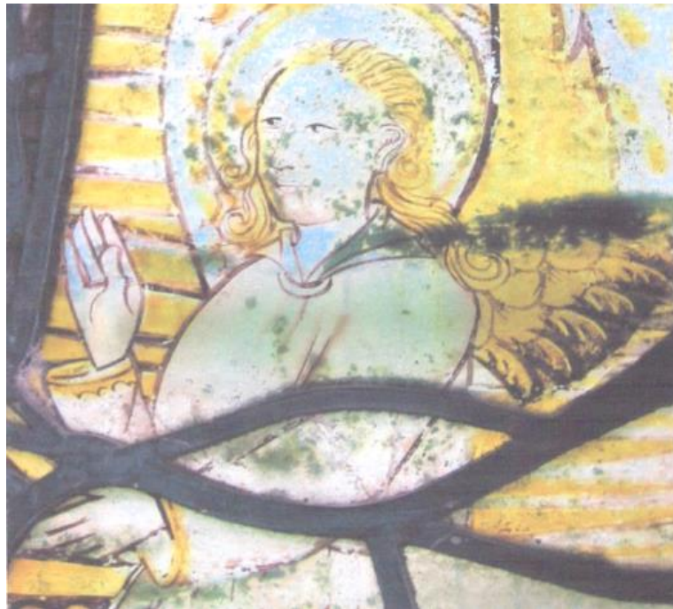
صورة رقم (١٨) من كنيسة Oxford Shire – Newington بإنجلترا توضح التبقع الفطري
