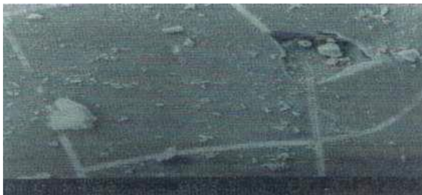
صورة رقم (١٠) صورة بالميكروسكوب الإلكتروني بنسبة تكبير ٤٠ X توضح مظهر الـ Incipient Crizzling
