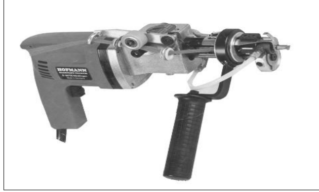
(شكل ٣) صورة للمسدس المستخدم في عملية غرز الوبرة
