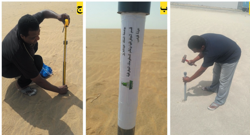
الشكل ٥. خطوات المرحلة الأولى للقياس: أ- تثبيت، ب- عينة قياس الزحف الرملي، ج- أخذ قياس مبدئي
