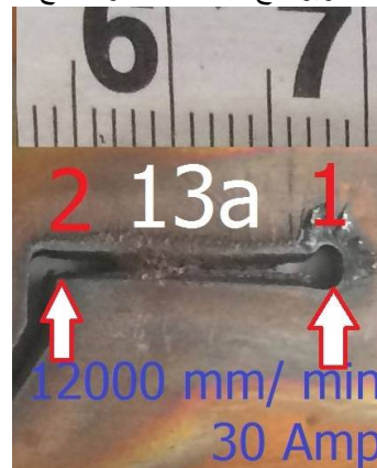
الشكل (7) يوضح منظر (13a,b) مسار القطع من الأمام والخلف للعينة 13 عند قدرة تيار 30 أمبير وسرعة قطع 12000م/د.
