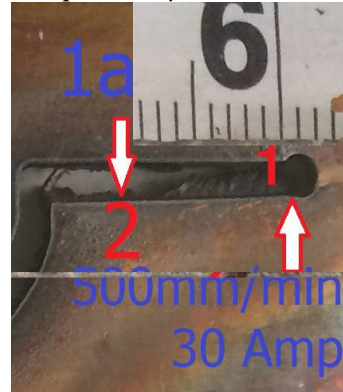
الشكل (6) يوضح منظر (1a,b) مسار القطع من الأمام والخلف للعينة 1 عند قدرة تيار 30 أمبير وسرعة قطع 500م/د.
