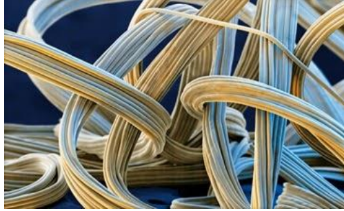
شكل رقم ( 2 ) الفحص الميكروسكبي لليكرا
