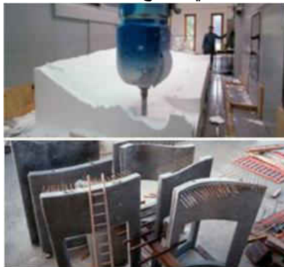
شكل (4): تصنيع الحوائط الخرسانية لمبنى زولهوف "Zollhof" سابقة التجهيز [13] .
