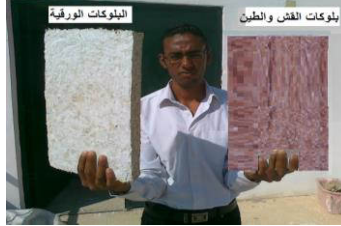
شكل (21): يوضح شكل المنتج النهائي لبلوكات العزل بأبعاد 5*30*50 سم.
