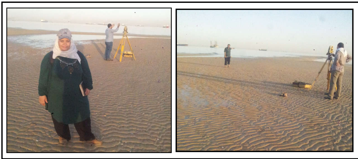
شكل (٢١) استخدام جهاز توتل استيشن في رفع القطاعات على سطح رأس الأدبية
