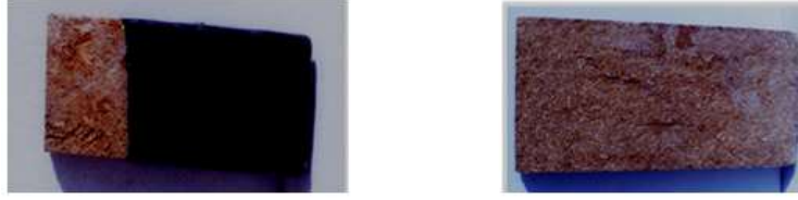
شكل (11): حماية البلوكات العازلة من الرطوبة باستخدام أكياس بلاستيك مفرغة الهواء أو دهان البيتومين (القار). (الباحث)
