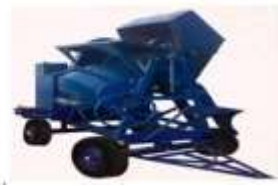
شكل (6): بعض أنواع الخلاطات لخلط القش والطين، وماكينة دمك الألواح العازلة.
