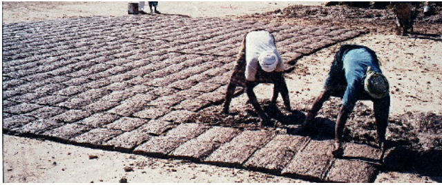
شكل ١٠: صورة توضح طريقة إنتاج الطوب الطيني المجفف بواسطة أشعة الشمس والذي يسمى محليا (بالمدر) بواسطة القالب الخشبي (المقتل).
