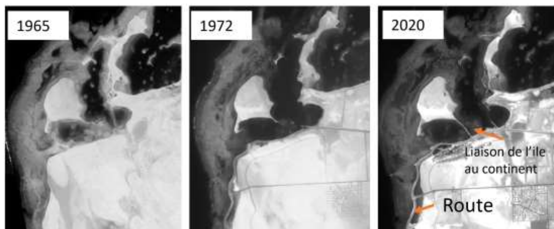
Figure 10. Changements dans la configuration du littoral au sud du port entre 1965 et 2020 ; jonction de l'île de Ghurab au continent et construction d'une route littorale sur un récif
