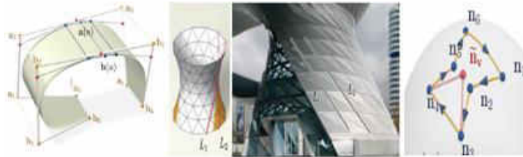
الشكل رقم (3): يبين نقاط التحكم وممسات الاقواس للتحكم في هذه الأسطح (NURBS) بطريقة سهلة يطلق عليها البارامتر المصدر:
