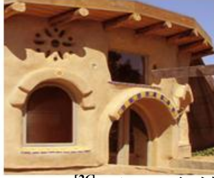
شكل رقم (15): فكرة حماية الجدران الطينية بسقف بارز [26]
