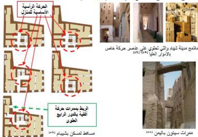
شكل (24): خصوصية ربط المساكن ببعضها في الأدوار العليا بمدينة شيبام وسينون باليمن
