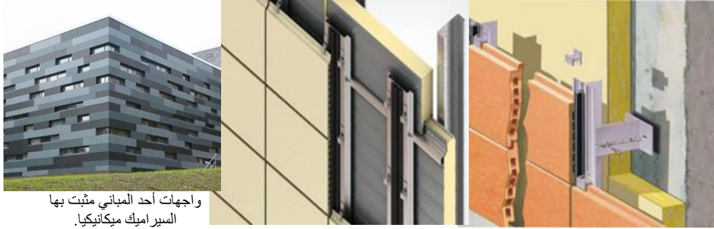
شكل (١٩): يوضح تركيب السيراميك ميكانيكيا وترك مسافة خلفه لزيادة عملية العزل الحراري [٣١].
