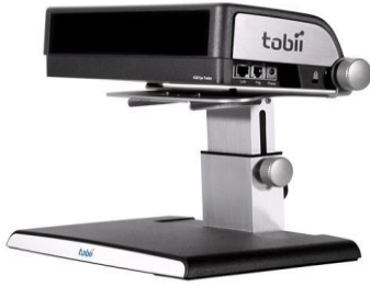
شكل (4) يوضح جهاز تتبع حركة العين
