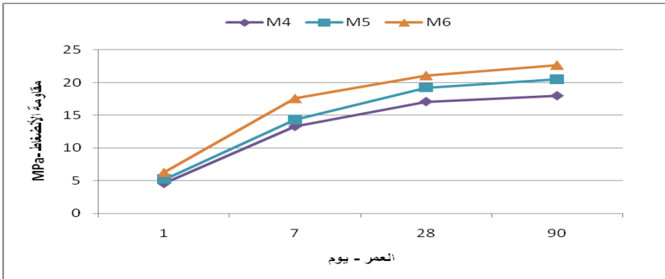
شكل (3) علاقة مقاومة الانضغاط مع العمر للخلطات الخرسانية المكونة من الركام الناعم الاعتيادي
