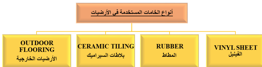
شكل رقم: (2) يوضح أنواع الخامات المستخدمة في الأرضيات
