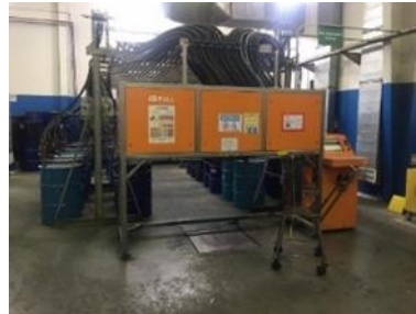
شكل رقم (8) جهاز خلط الأحبار بمطابع العبيكان
