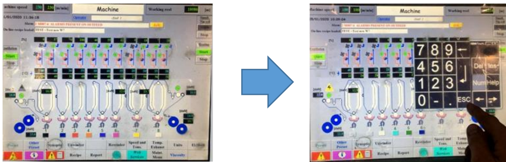
شكل رقم (10) يوضح عمليات الضبط للشد بالمناطق المختلفة للماكينة
