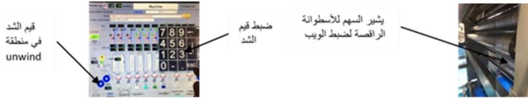
شكل رقم (12) (للأسطوانة الراقصة التقليدية) لضبط عمليات الشد بماكينته comex1 بمطابع العبيكان
