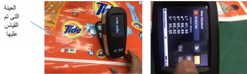
شكل (14) جهاز الاسبكترودنستوميتر X RITE
