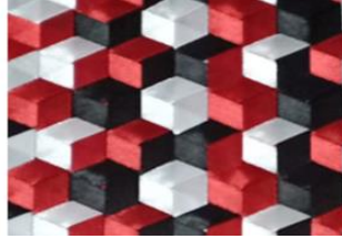
صورة (25) نسيج يدوى غير منتظم، ستان (أسود س، أبيض ل1، أحمر ل2)
