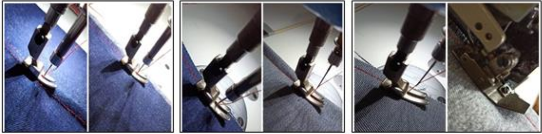
شكل (1) طريقة تنفيذ الوصلة العادية و الوصلة الفرنسية و الوصلة الانجليزية
