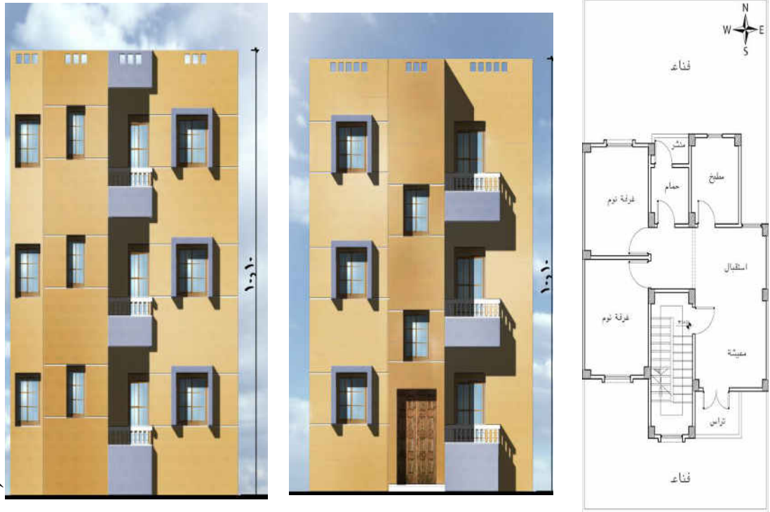
المسقط الأفقي للدور المتكرر [1] الواجهة الأمامية لنموذج (ع) – جارين الواجهة الخلفية لنموذج (ع) - جارين
