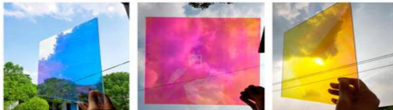
شكل رقم (18) الزجاج المزدوج حيث يتغير لونه بتغير الضوء على مدار النهار.
