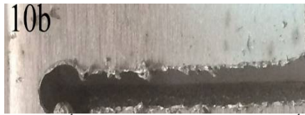
الشكل (6) يوضح منظر مسار القطع من أعلى ومن أسفل للعينة 10 عند قدرة تيار 150 أمبير وسرعة قطع 800م/د.
