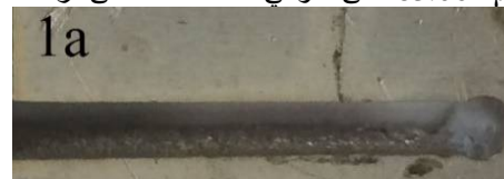
الشكل (7) يوضح منظر لمسار القطع من أعلى ومن أسفل للعينة 1 عند قدرة تيار 150 أمبير وسرعة قطع 1100م/د.
