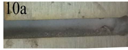
الشكل (6) يوضح منظر مسار القطع من أعلى ومن أسفل للعينة 10 عند قدرة تيار 150 أمبير وسرعة قطع 800م/د.
