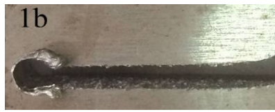
الشكل (7) يوضح منظر لمسار القطع من أعلى ومن أسفل للعينة 1 عند قدرة تيار 150 أمبير وسرعة قطع 1100م/د.
