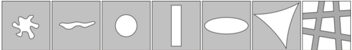
شكل (3) الأنواع المختلفة لمسام قماش قناع الوجه، منها المسام ذات المقطع المنتظم هندسياً (أسطوانية أو مخروطية) أو المسام ذات المقطع الغير منتظم هندسياً
