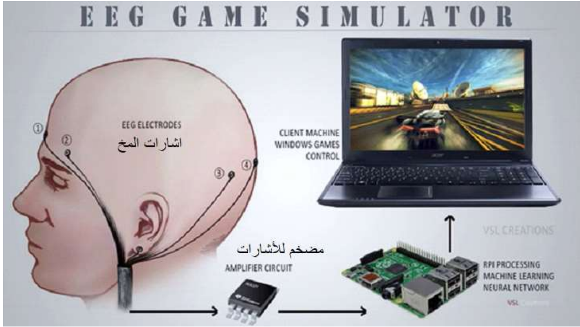
شكل (١١) كيفية قياس اشارات المخ لإظهارها على الكمبيوتر
